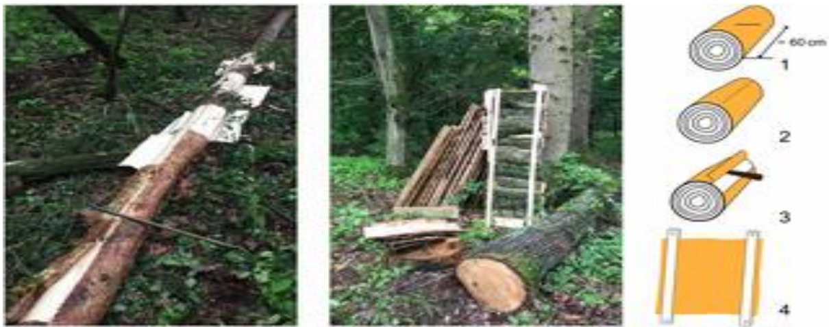
Obr. 1 Metodický postup odkôrňovania a výroba vzoriek kôry
