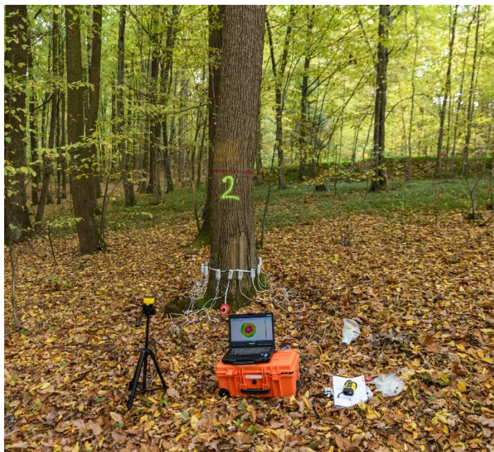
Obrázok 2 Senzory impulzného tomografu Arbotom umiestnené po obvode dreva a grafická vizualizácia identifikovaných defektov v dreve.
