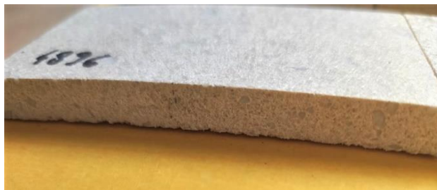
Obrázok 3 Vzorka nenasiakavej stavebnej veľkometrážnej drevoplastovej dosky Zdroj (vlastné spracovanie)
